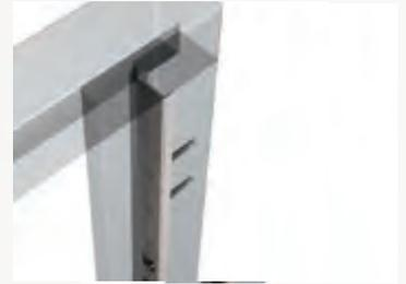
Aus hochwertigem gebürstetem Edelstahl bestehen sowohl Schlossstulp als auch Schließeiste. Beide sind durchgehend auf voller Länge und in U-Form gekantet und in das Holz eingelassen. Diese Variante stabilisiert nicht nur, sie verhindert zuverlässig das Hintergreifen mit Aufhebelwerkzeuge.
