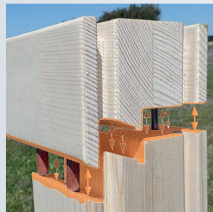
Vor dem Zusammenbau werden alle Teile lackiert, auch das Hirnholz
