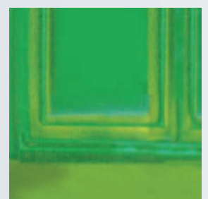
Bei angefräster Glasleiste verhindert der dichte Fensterflügel Wärmeverluste
